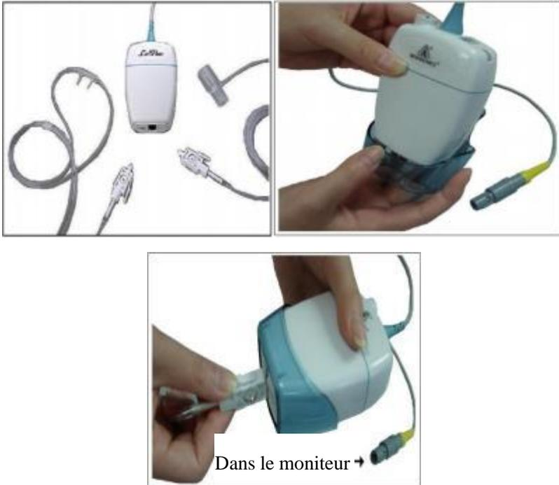
Figure 16-3 Schéma 1 de connexion au CO<sub>2</sub> de Respironics Sidestream
