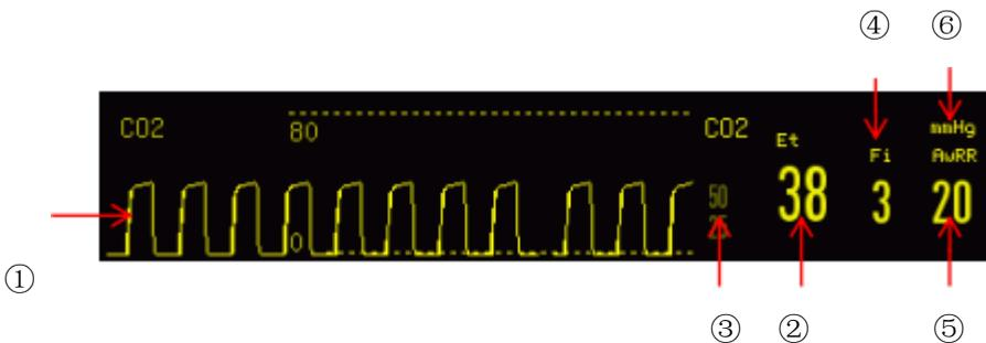
Figure 16- 1 Affichage de la forme d'onde et des paramètres CO<sub>2</sub>
